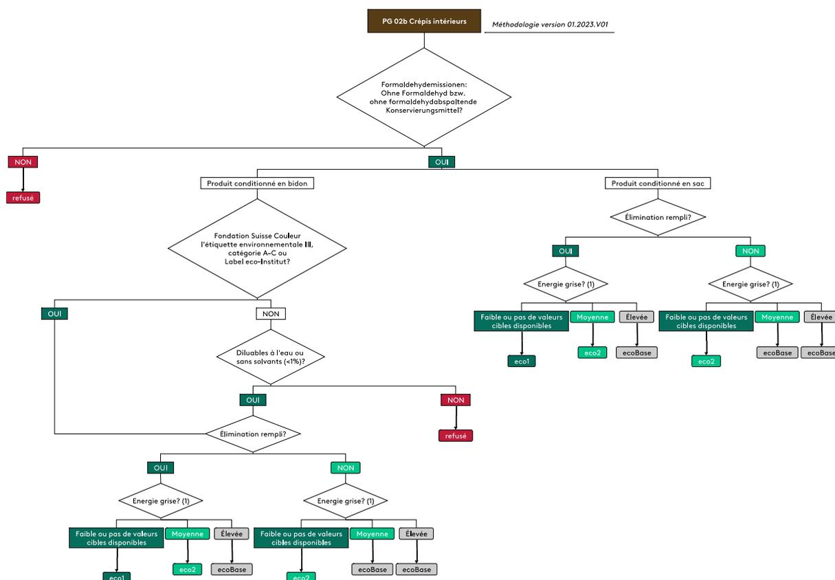
(1) L'énergie grise est calculée spécifiquement pour chaque produit sur la base de sa composition (calculateur d'enduit ecobau version 2023).
