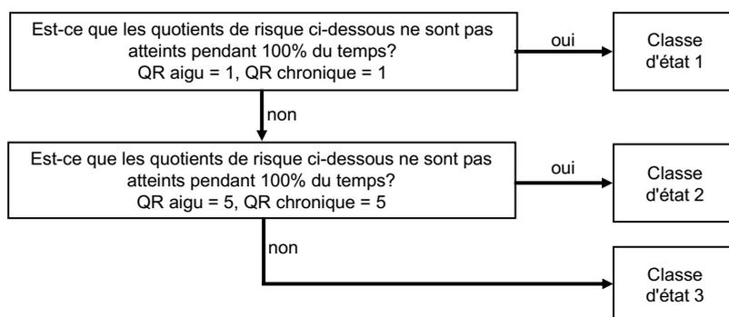
Figure 9: Schéma pour l'évaluation basée sur les émissions
