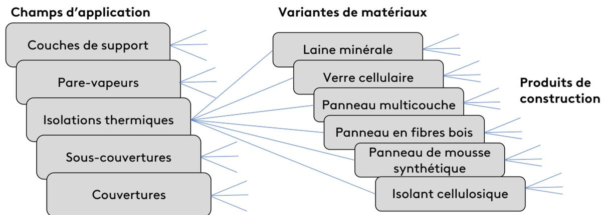
Figure 4: Les champs d'application les plus importants pour l'ensemble des couches d'un toit en pente.
