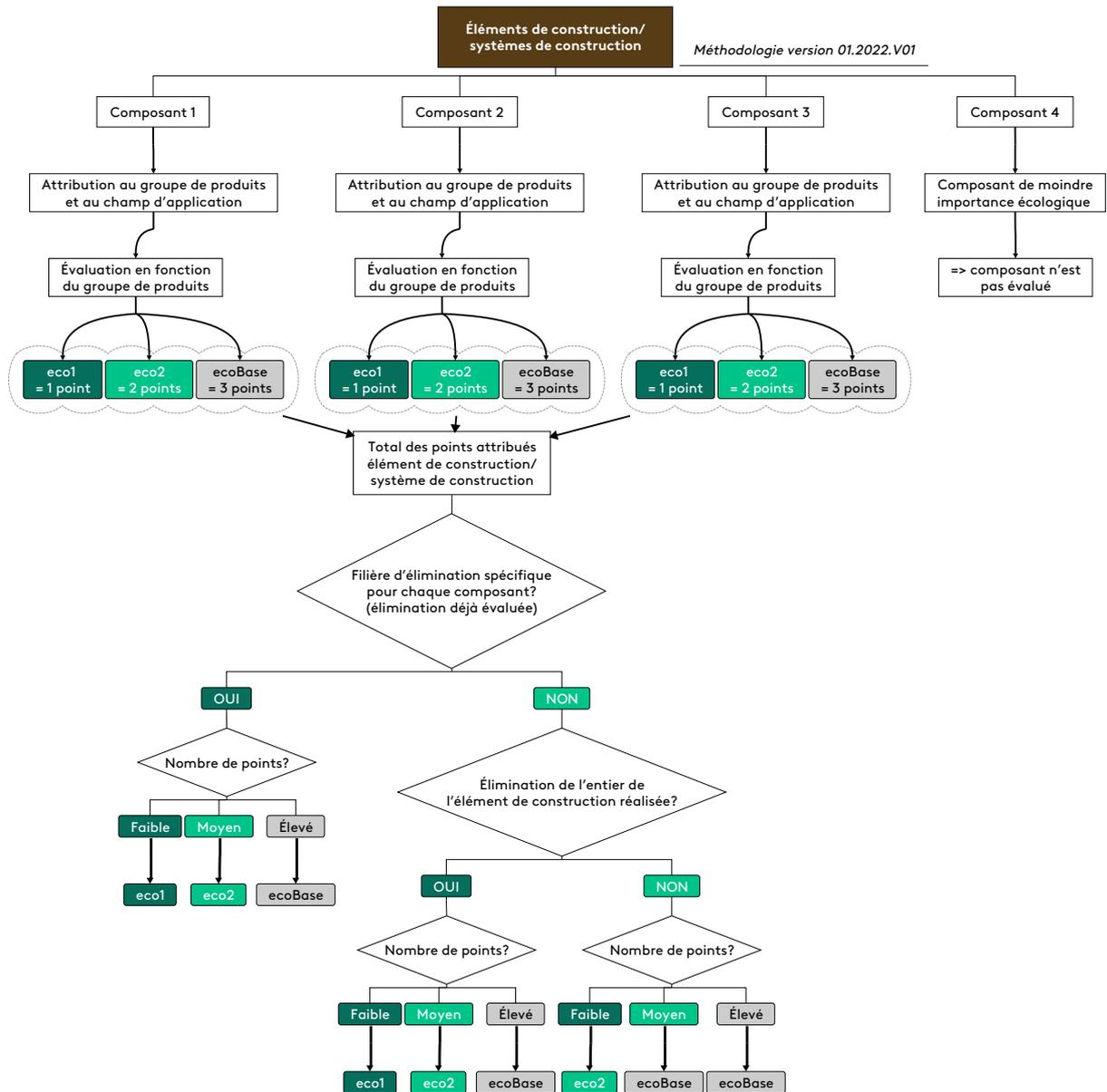
Figure 6: Évaluation d'éléments de construction et de systèmes
