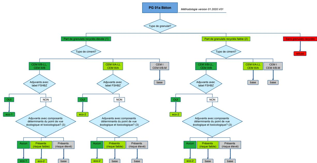
(1) Part de granulats recyclés\* élevée: Béton constructif:  $R_c + R_b \geq 40\%^{**}$ ; béton maigre:  $R_c + R_b \geq 80\%$
