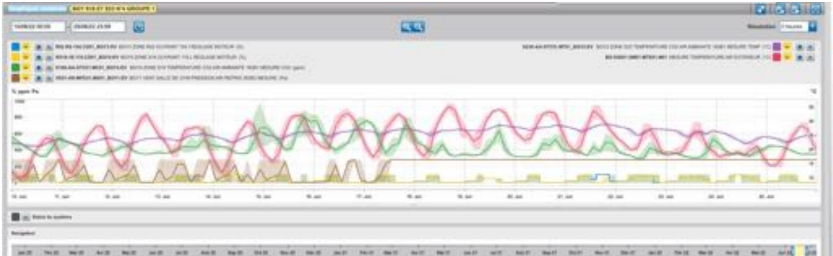
Supervision T° int. et ext. et CO2 juin 2022. IDC 2020 mesuré 100 MJ/m<sup>2</sup> an, 28 kWh/m<sup>2</sup> an.
